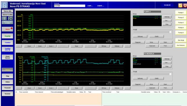
Stazione di pompaggio Štrand: parametri di sistema e misurazione della corrente, della pressione e della portata.
