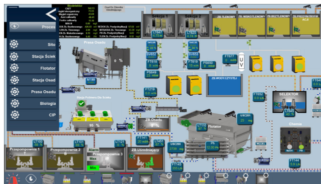
Panel operatorski z interfejsem części mechaniczno-chemicznej oraz biologicznej
